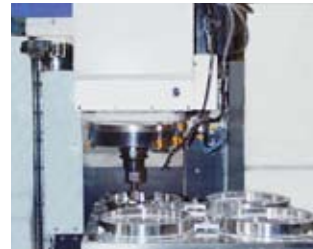
グッドデザインとイナーシャの減少のため、外周部の軽量化は特に重要。取付精度とバランス精度の確保のため、マシニングセンターが最適です。
