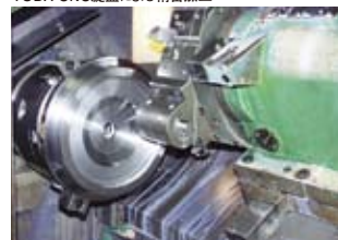
TODAフライホイールは、応力分散による強度アップのため、断面に曲線ラインを多用したオリジナルデザイン。細部にまで正確な加工を必要とするため、CNC旋盤は不可欠です。
