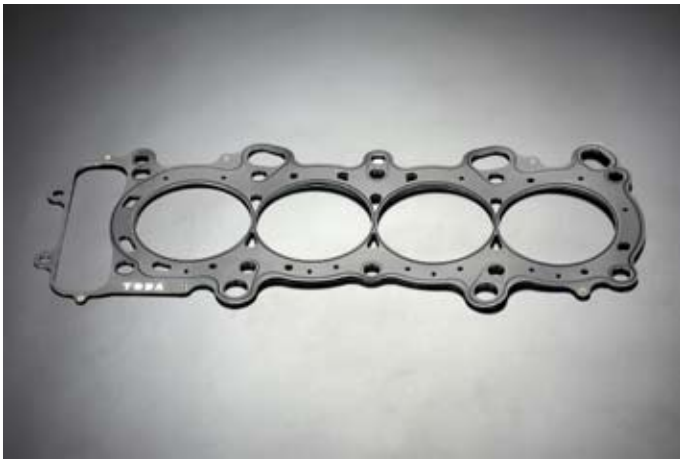
F20C/F22C用 メタルヘッドガスケット (90mm ボア/ t=1.1mm 仕様)
