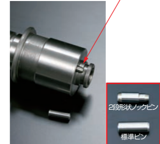
4AG 20V カムシャフト 2段形状ノックピン取付図
